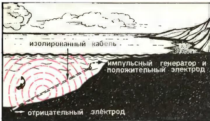
Схема отпугивающего акул устройства.
